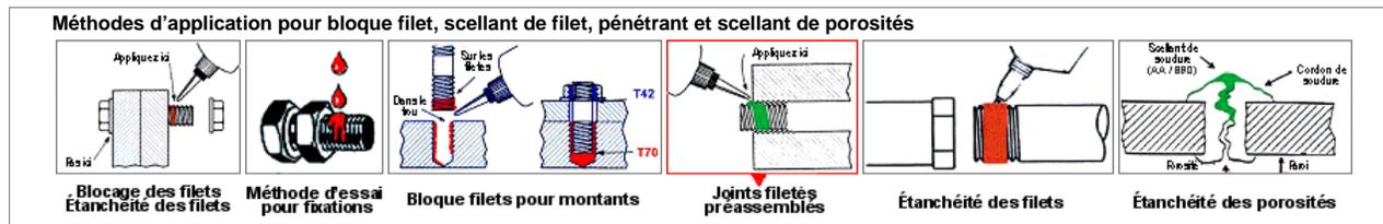
Cette méthode se réfère à l'application de l'adhésif anaérobie **S90** sur joints pré-assemblés. Le scellant de filet S90 est un composé à action capillaire qui pénètre et scelle les joints filetés pré-assemblés.
